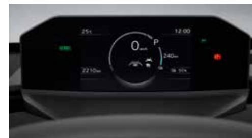
Schermo LCD Lo schermo LCD TFT da 7" montato in alto presenta un design avanzato. Posizionato sopra il volante, la sua disposizione riduce al minimo il movimento degli occhi permettendo al guidatore di rimanere concentrato sulla strada.
